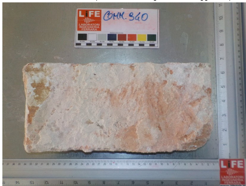
Figura 8: prelievo di campioni mediante asportazione di blocchi
